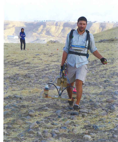
Abb. 5 Der Geophysiker und Archäologe Andrei Așandulesei (Universitatea «Alexandru Ioan Cuza» Iași, Rumänien) trägt für die geomagnetische Prospektion das Cesium-Magnetometer entlang der Schnüre des Messnetzes über Qalat-i Dinka.
